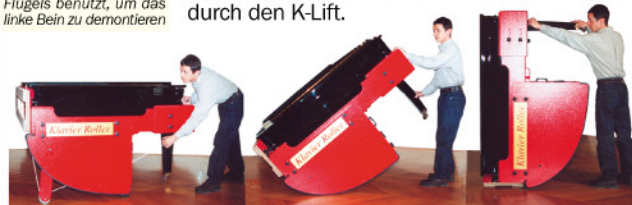
Der ausklappbare Hilfsfuß wird zum Anheben des Flügels benutzt, um das linke Bein zu demontieren
