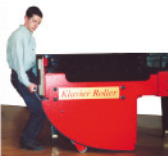
Der ausklappbare Hilfsfuß wird zum Anheben des Flügels benutzt, um das linke Bein zu demontieren
